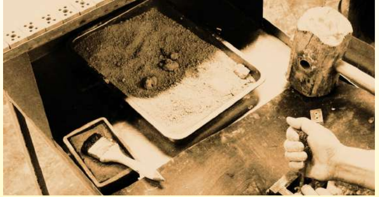
Blocchi terminali in porcellana realizzati a mano mediante pressatura a martello: Riempimento manuale del granulato umido (Collezione privata) Essiccazione della porcellana elettrica dopo la pressatura (Collezione privata)
