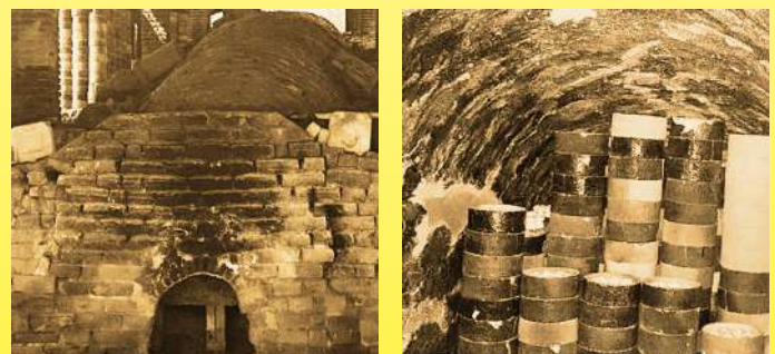
Forno tradizionale cinese a drago (龙窑 Long Yao), bocca di alimentazione e metodo di riempimento con porcellane elettriche (collezione privata)
